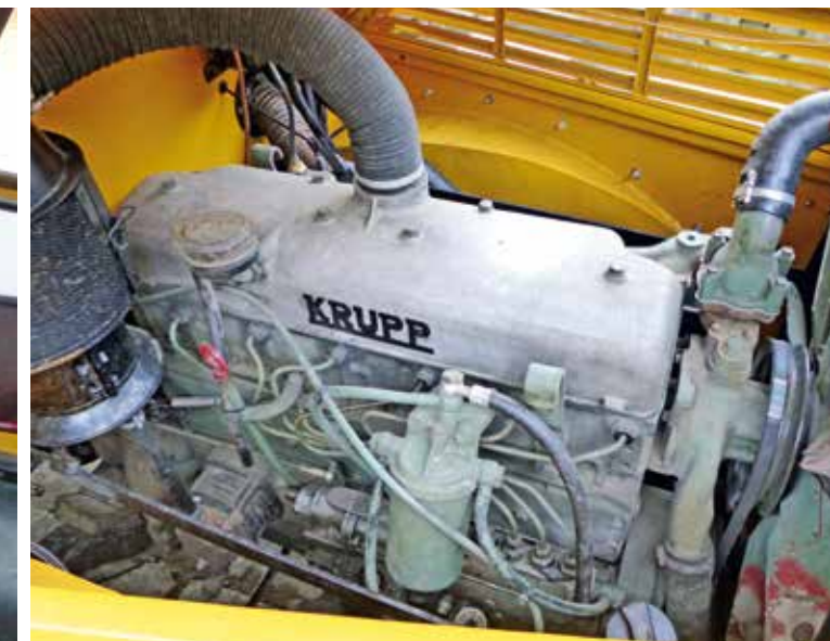
Sześciocylindrowy silnik wysokoprężny, mimo niezbyt imponującej mocy (55KM), całkiem nieźle daje sobie radę z napędem autobusu
