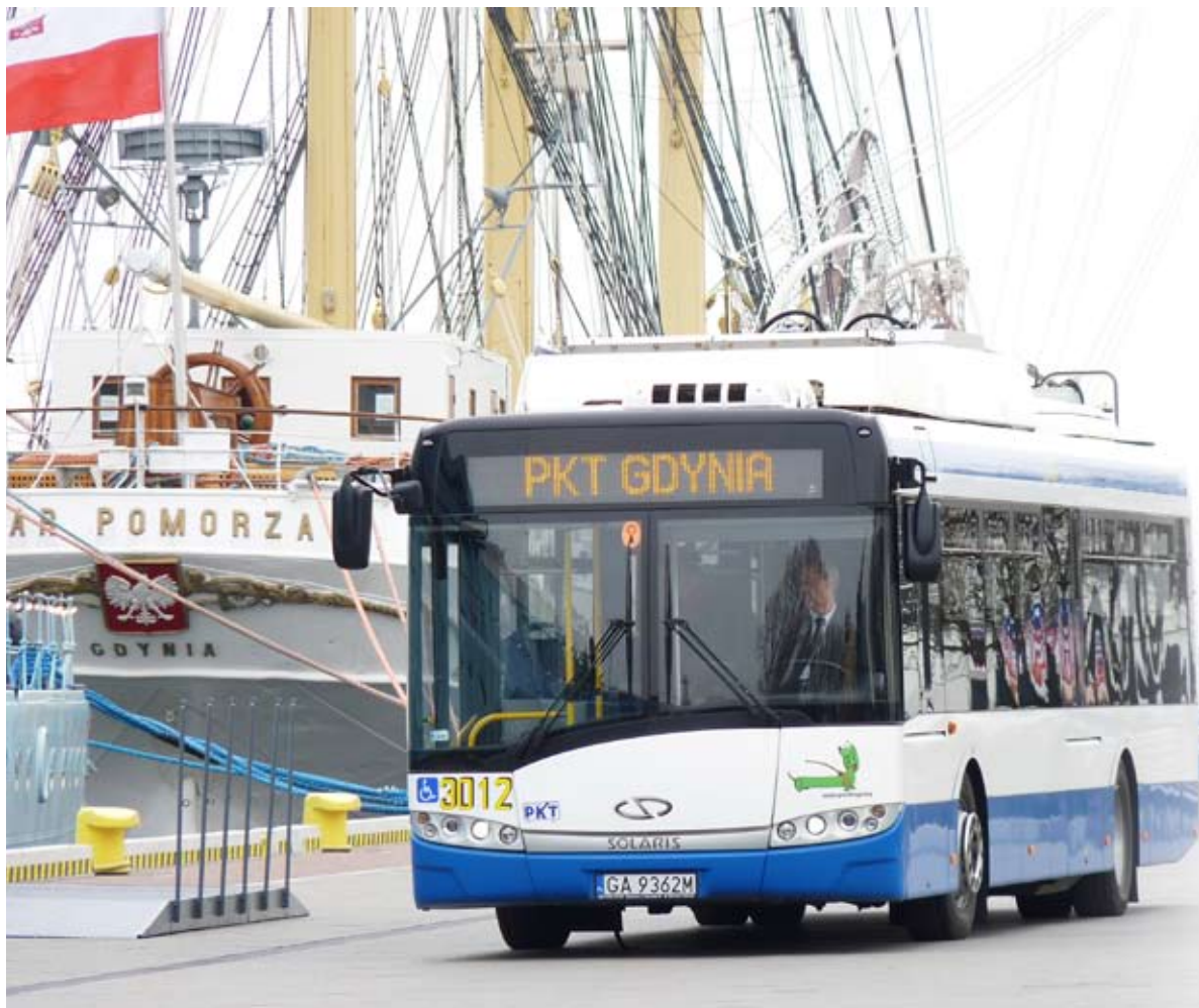
Fot. Marcin Połom. Trolejbus Solaris Trollino 12M z dodatkowymi bateriami akumulatorów umieszczonymi na dachu
